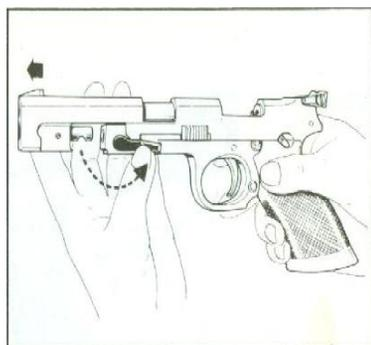
Tourner de 180° (en sens contraire à celui des aiguilles d'une montre) le levier de blocage et glisser en avant le contrepoids.
