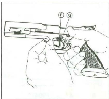
Pour régler la pré-course de la détente, agir sur la vis (F) avec la clef spéciale. Pour augmenter ou réduire la pression de la première phase de la détente il faut tourner la vis (G).
